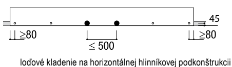
ložové kladenie na horizontálnej hliníkovej podkonštrukcii
